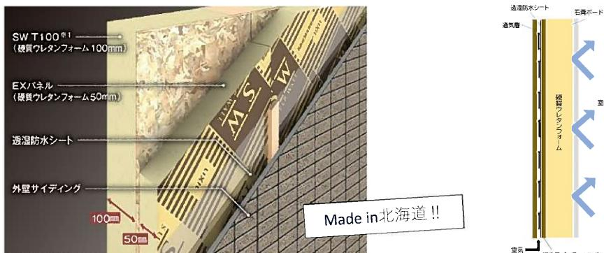
通気層構造と高性能断熱材が住まいの耐久性を高めます。
